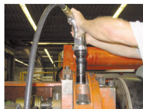
Torsionsfreies Verspannen mit der CLAMP™
